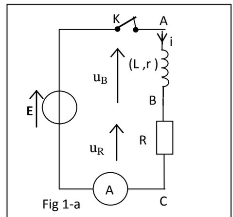
b- La solution de cette équation différentielle est de la forme :  $u_R(t) = U_{R_{\max}} (1 - e^{-\frac{t}{\tau}})$ . Avec  $U_{R_{\max}}$  et  $\tau$
